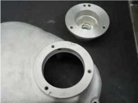
Kupplungsdeckel demontieren und reinigen
