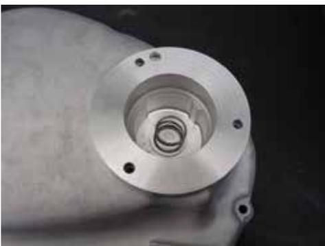
Ölfiltergehäuse in den Deckel einsetzen und ...
