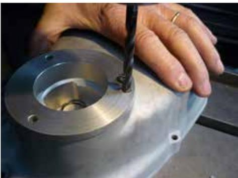
Mit einem 6,5m-Bohrer 2-3 Millimeter tief anbohren
