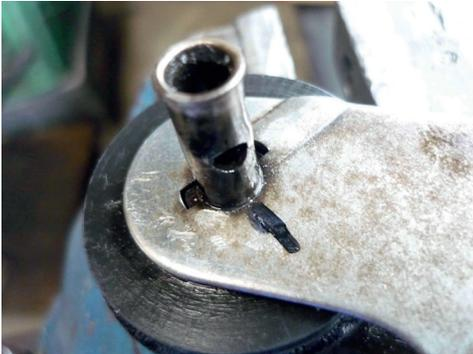
Umdrehen, Position der Ölbohrung markieren
