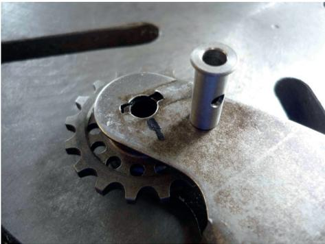
Neue Hülse: Ölbohrung ausrichten
