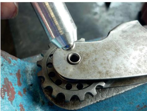
Mit Kugelnietwerkzeug o.ä. vernieten
